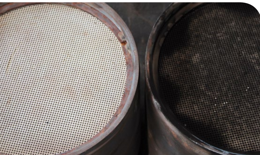
Gereinigter (links) und nicht gereinigter DPF im Vergleich; Foto: VCD
